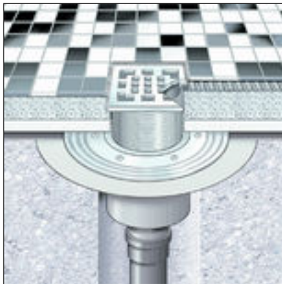
Bild 3: Schema för en konventionell tätning
