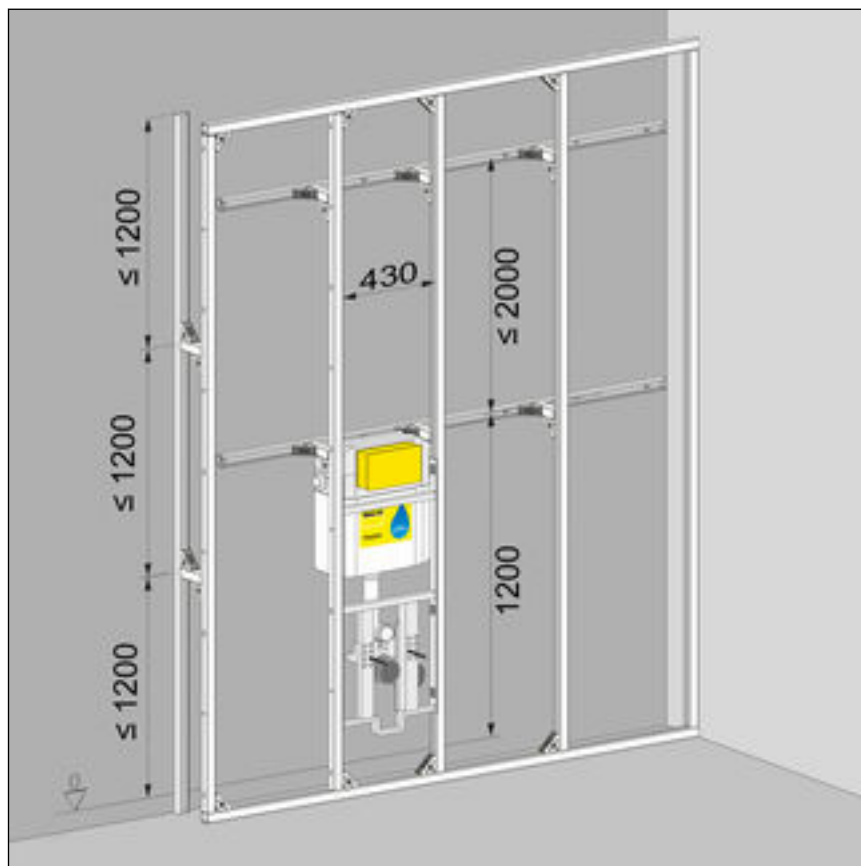
Obr. 4: Montážne rozmery – predná stena na výšku priestoru
