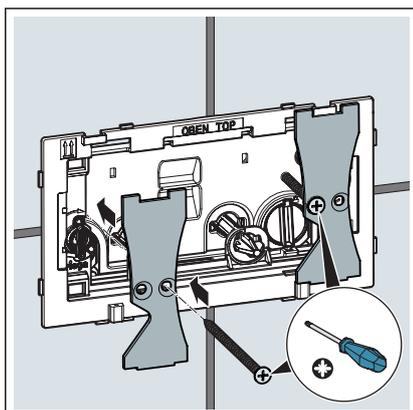
► Aparafusar as placas de fixação.
