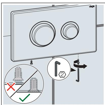
► Aparafusar a placa de acionamento com uma chave Allen (SW 2).
