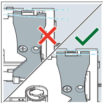
► Verificar o posicionamento das placas de fixação e, se necessário, retificar.
