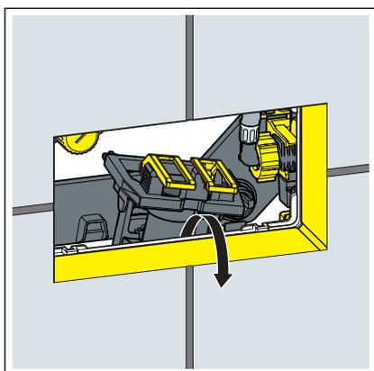
► Levantar a válvula de descarga.
