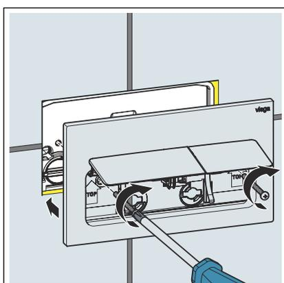
► Encaixar e aparafusar a placa de acionamento.
