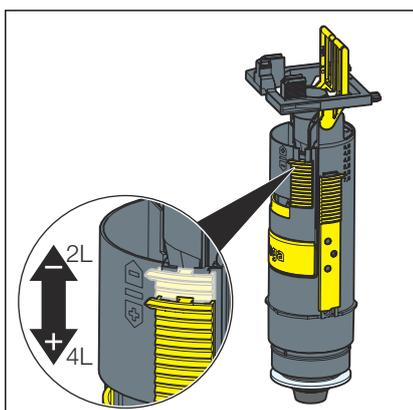
► Ajustar o volume de descarga pequeno na válvula de descarga.
