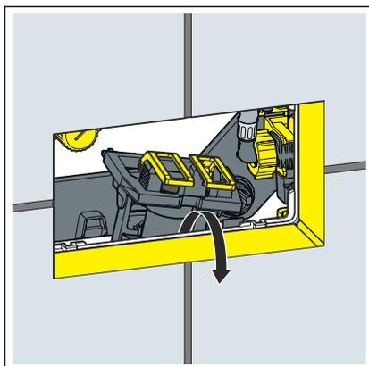
► Levantar a válvula de descarga.
