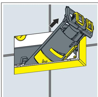
► Retirar a válvula de descarga pela abertura de inspeção.
