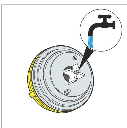
► Se necessário, limpar a válvula de membrana sob água corrente.
