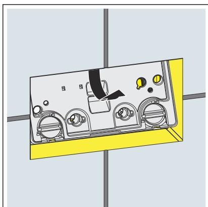
► Remover a placa de proteção de montagem.
