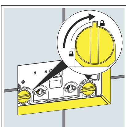
► Rodar o bloqueio da placa de proteção de montagem 90° no sentido horário.
