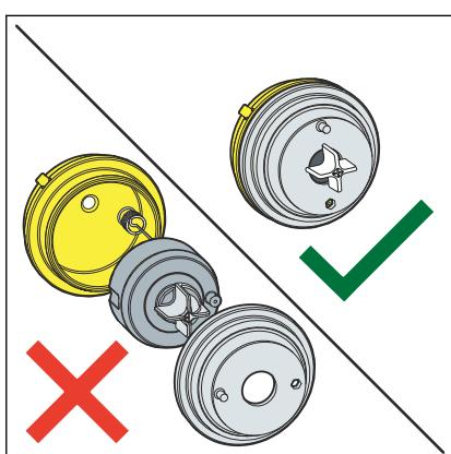
**AVISO!** Não desmonte os componentes da válvula de membrana para evitar danos.
