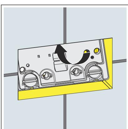
► Inserir a placa de proteção de montagem no autoclismo.
