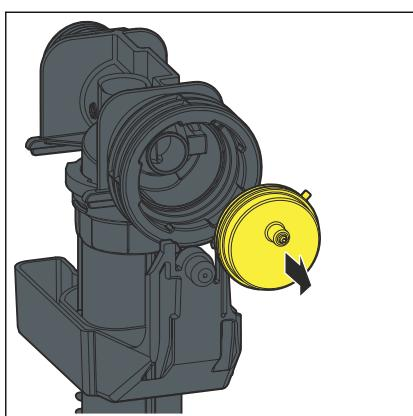
► Desmontar a válvula de membrana.
