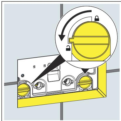
► Rodar o bloqueio da placa de proteção de montagem 90° no sentido anti-horário.
