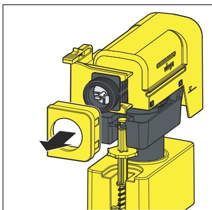
► Remover a fixação do suporte da válvula de enchimento.
