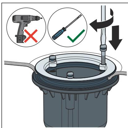
**AVISO!** Utilizar apenas chaves de fenda, não utilizar uma aparafusadora sem fio.
