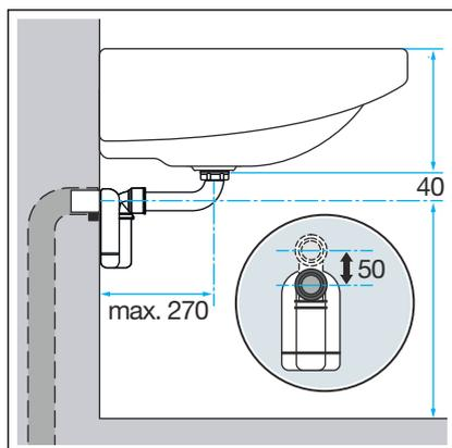
Fig. 2: Dimensões de montagem
