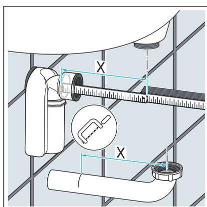
► Determinar o comprimento X da curva de descarga.
