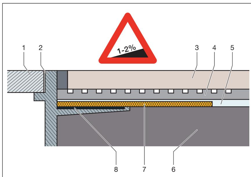
**Fig. 14: Esquema de montagem da impermeabilização líquida – inclinação da betonilha mín. 1-2%**
