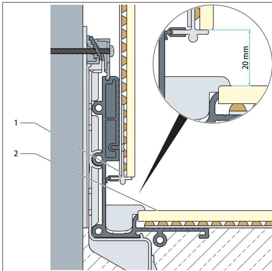
Fig. 21: Friso de remate montado, mosaicos da parede e do pavimento colocados
