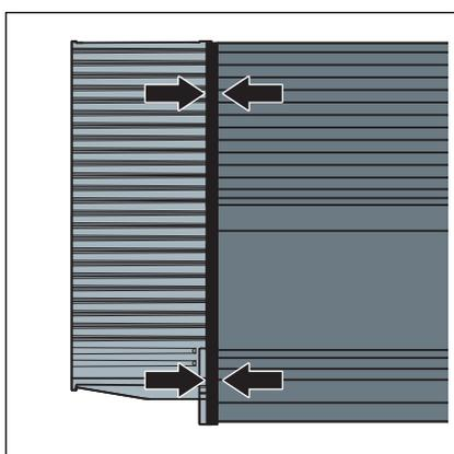
□ A peça de fecho está montada corretamente, se a vedação for pressionada **ligeiramente**.
