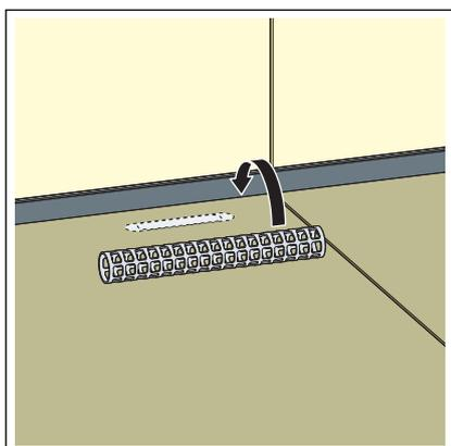
► Inserir o crivo acima do sumidouro na fenda da calha.
