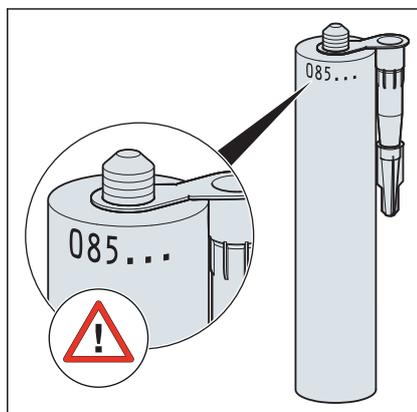
Fig. 16: Data de enchimento da cola de montagem
