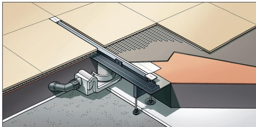
Fig. 13: Esquema de uma impermeabilização líquida
