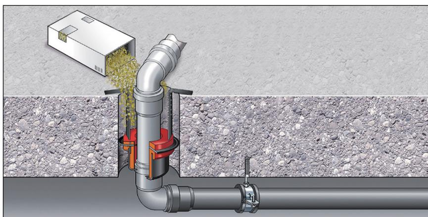
Fig. 15: Exemplo: passa-muro com proteção de incêndio
