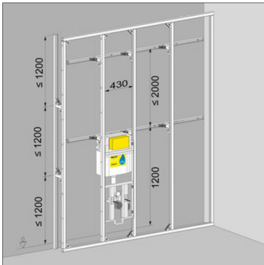
Fig. 4: Innbyggingsmål for romhøy frontvegg
