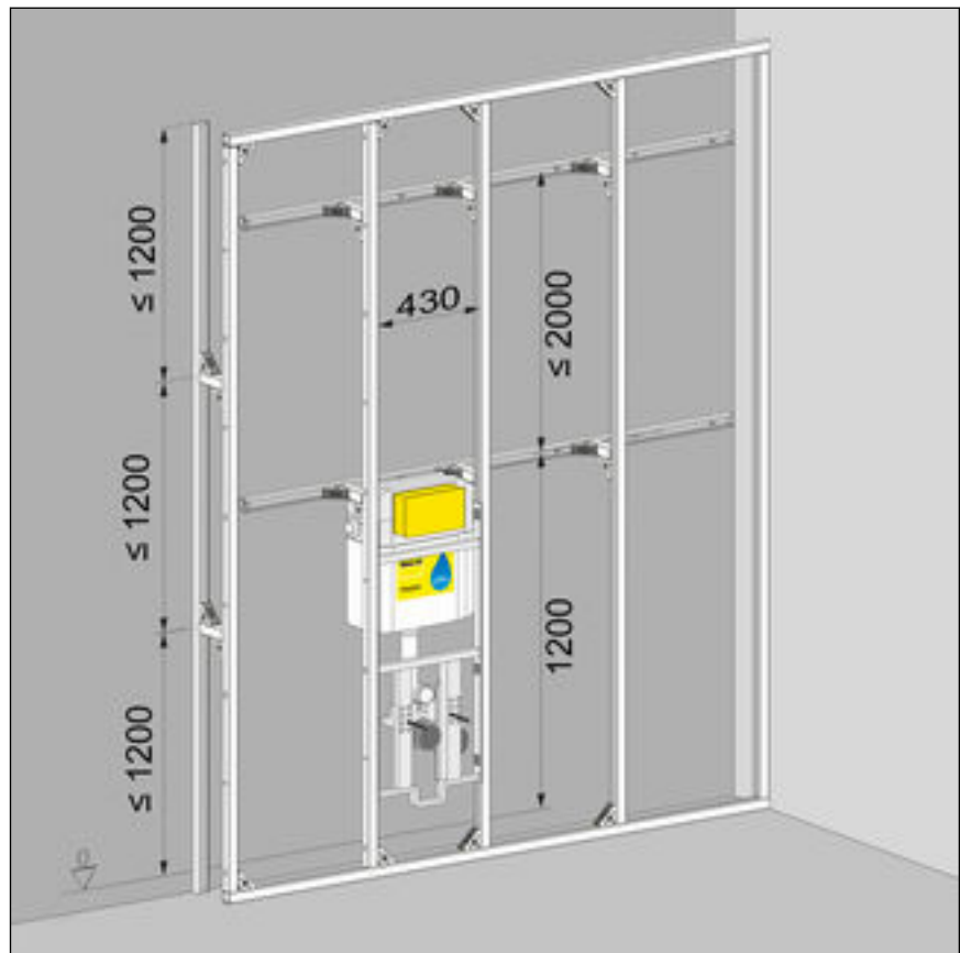
Afb. 4: Inbouwmaten kamerhoge voorwand
