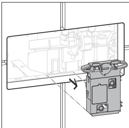
► Rimuovere e smaltire il dispositivo di azionamento meccanico.
