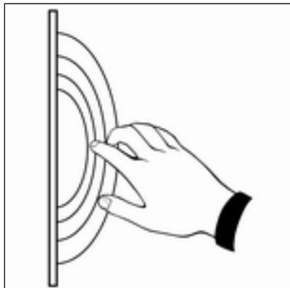
Fig. 9: Campo di rilevamento massimo (0–30 mm)
