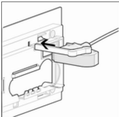
► Inserire l'unità cavi Bowden sul retro del telaio di supporto.
