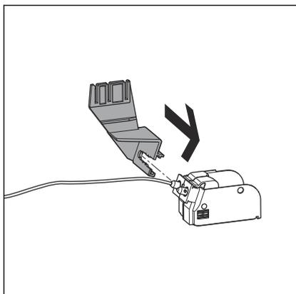
► Spingere il supporto per l'unità di azionamento da sinistra sull'unità cavi Bowden.
