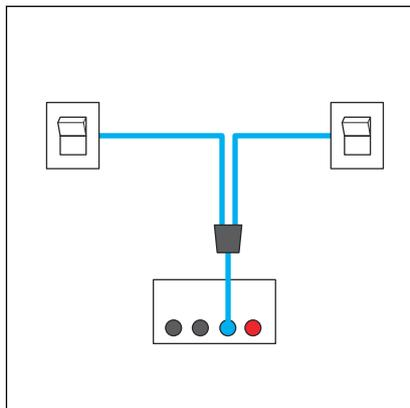
**Fig. 4: Collegamento di un secondo tasto esterno**
