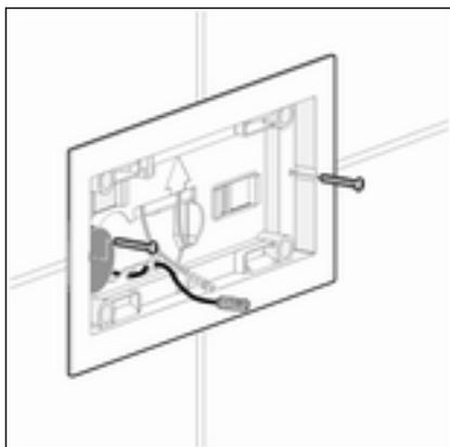
► Avvitare il telaio di supporto.
