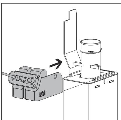
► Da sinistra, spingere l'unità cavi Bowden sulla valvola di scarico.
