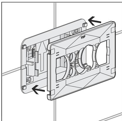
► Applicare l'elemento di sostegno sul telaio di supporto.
