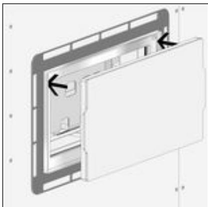
► Posizionare la copertura in dotazione sul telaio interno.
