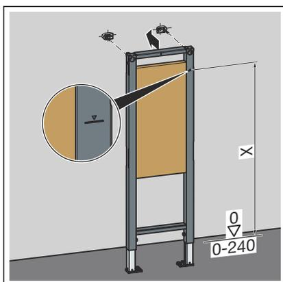
► Regolare l'altezza del modulo in base alla marcatura in cantiere del piano del pavimento finito.
