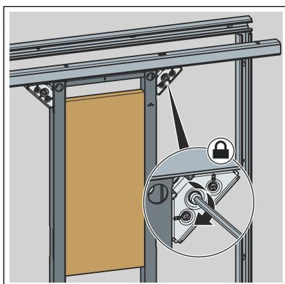
► Fissare il modulo con i raccordi Prevista Dry Plus.
