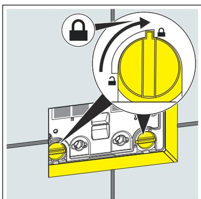
► Ruotare il bloccaggio della placca protezione da cantiere di 90° in senso orario.
