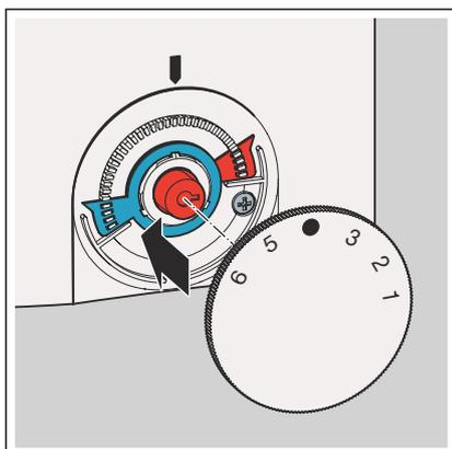
**AVVISO!** Posizionare la manopola sul termostato ambiente solo dopo aver montato il corpo superiore.
