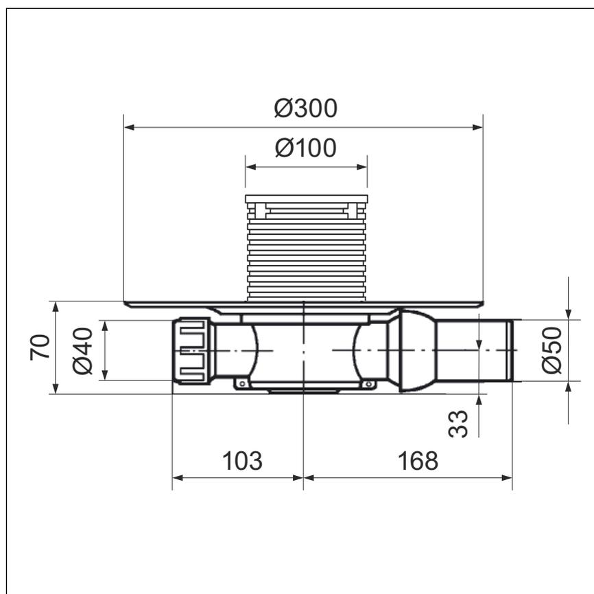
Fig. 5: Disegno dimensionale modello 4939
