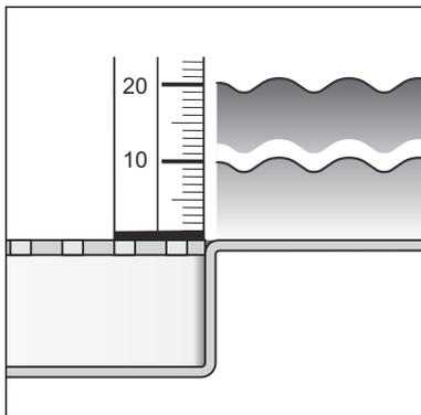
Capacità di scarico con un livello acqua di 10 mm al di sopra della griglia: 0,45 l/s
