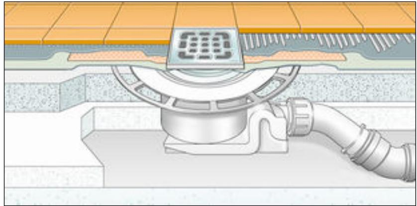
**Fig. 2: Schema di posa per impermeabilizzante fluido**
