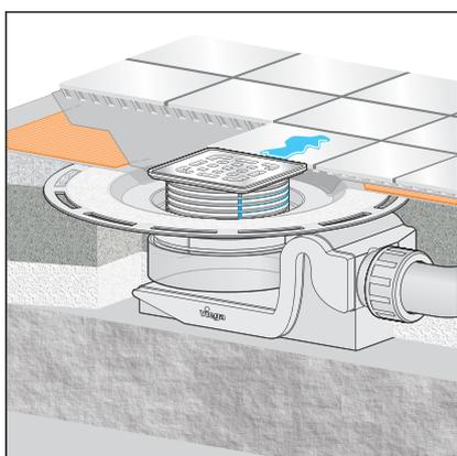
Fig. 1: Esempio di montaggio generale – montaggio nel solaio
