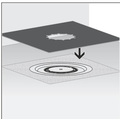
**INFORMAZIONE!** La guaina impermeabilizzante Viega è rivestita diversamente sui due lati. Un lato è rivestito con bitume e uno con EPDM. Se il resto dell'impermeabilizzazione avviene con guaine impermeabilizzanti in bitume, la guaina impermeabilizzante deve essere usata con il lato rivestito di bitume rivolto verso l'alto. Se vengono usate guaine impermeabilizzanti di EPDM, il lato rivestito in EPDM deve essere rivolto verso l'alto.
