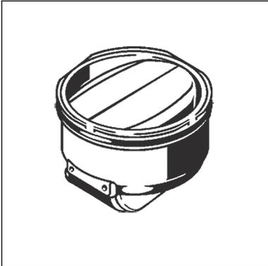
Gli scarichi Advantix possono essere dotati di una chiusura antiodore supplementare per chiudere lo scarico senza far uscire gli odori se la colonna d'acqua nel sifone è asciutta. Fastidiosi odori vengono così evitati anche in scarichi poco usati. Per le chiusure antiodore consultare il catalogo.
