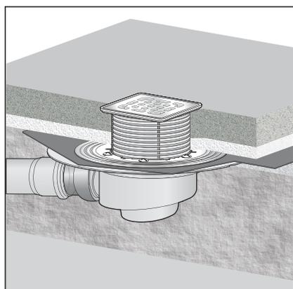
Fig. 1: Esempio di montaggio generale – incavo del solaio
