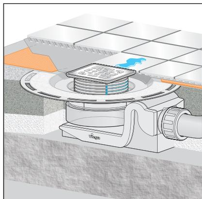
Fig. 2: Esempio di montaggio generale – montaggio nel solaio
