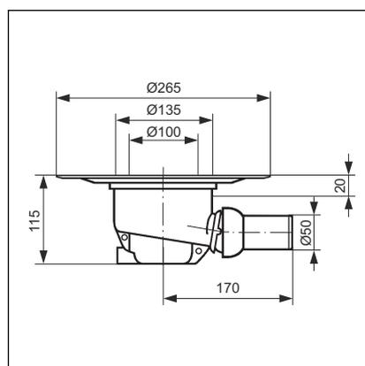
Fig. 7: Disegno dimensionale modello 4921.3
