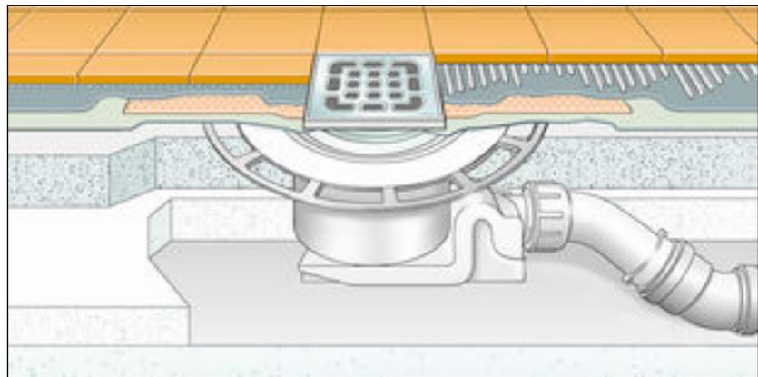
Fig. 4: Schema di posa per impermeabilizzante fluido
