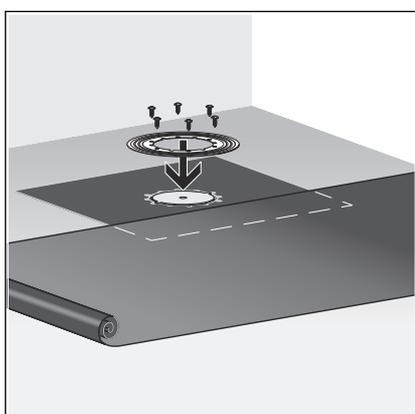
► Allineare la flangia di supporto per impermeabilizzazione sulla guaina impermeabilizzante in modo tale che i fori di fissaggio siano visibili.
