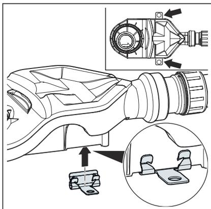
► Montare le clip di fissaggio.
