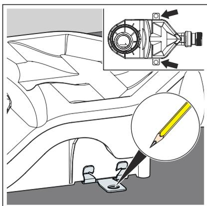
► Contrassegnare i punti di fissaggio sul pavimento.
