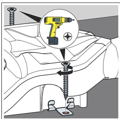
► Avvitare le clip di fissaggio al pavimento.
