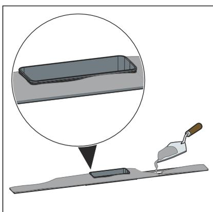
► Applicare il collante per piastrelle su tutta la superficie del profilo della Corriacqua e sul raccordo di compensazione.
