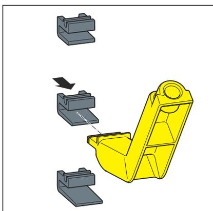
► Spingere il supporto griglia sull'utensile di montaggio.
