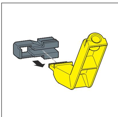
► Esempio di montaggio lato sinistro: spingere il supporto griglia sull'utensile di montaggio.
