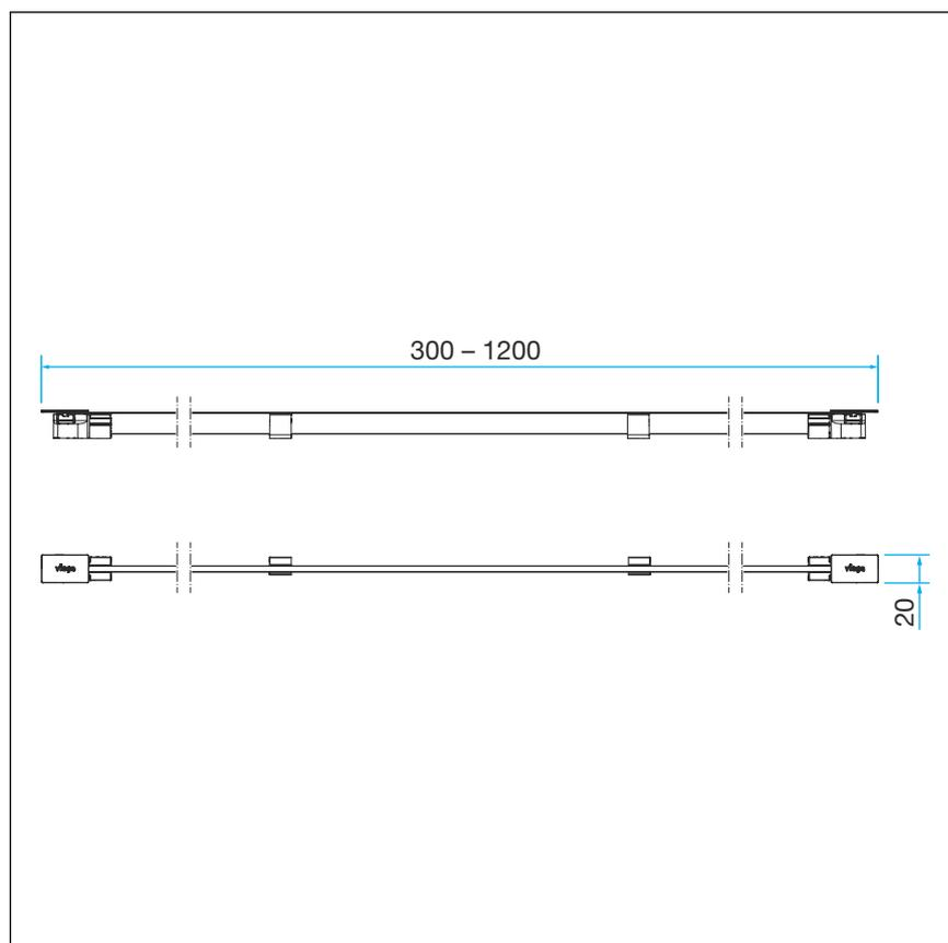
Fig. 2: Dimensioni di montaggio
