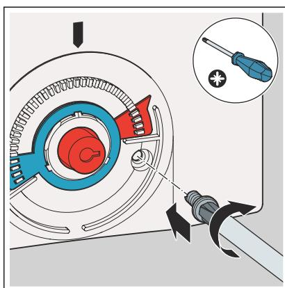
► Vijcima pričvrstite gornji dio kućišta na podnožje kućišta.
