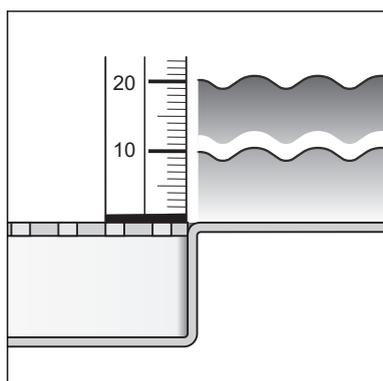
Débit d'écoulement avec une hauteur d'eau de 10 mm au-dessus de la grille : 0,7 l/s
