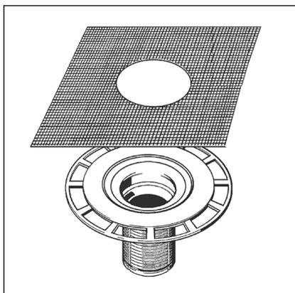
Si une étanchéité composite doit être réalisée, un élément de rehausse adapté avec natte d'étanchéité est requis.
