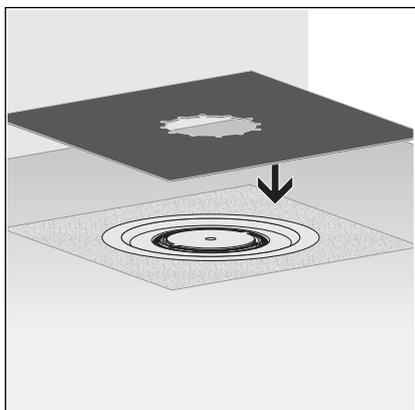
**INFORMATION !** La natte d'étanchéité Viega est dotée d'un revêtement différent des deux côtés. Un côté est revêtu de bitume et l'autre d'EPDM. Si l'étanchement se poursuit à l'aide de bandes d'étanchéité en bitume, la natte d'étanchéité doit être utilisée avec le côté bitume vers le haut. Si des bandes d'étanchéité en EPDM sont utilisées, le côté EPDM doit être orienté vers le haut.
