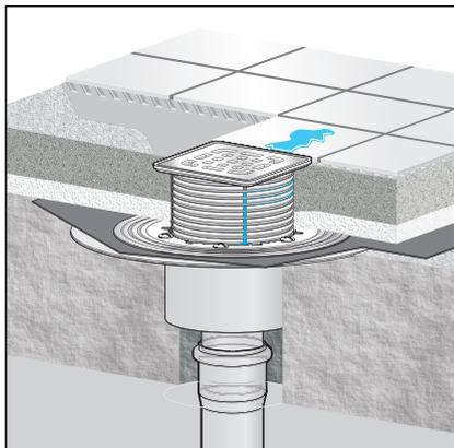
Fig. 1 : Exemple de montage général – carottage
