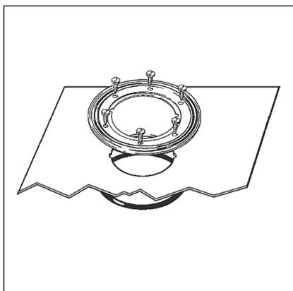
Si une étanchéité conventionnelle doit être réalisée, une natte d'étanchéité et une bague de serrage adaptées sont requises.
