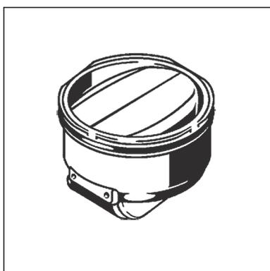
Les écoulements Advantix peuvent être dotés d'un clapet anti-odeur supplémentaire qui ferme l'écoulement empêchant ainsi les odeurs, même lorsque la garde d'eau dans le siphon anti-odeur a séché. Les nuisances olfactives sont ainsi empêchées, même dans le cas des écoulements à faible fréquence d'utilisation. Vous trouverez les clapets anti-odeur dans le catalogue.
