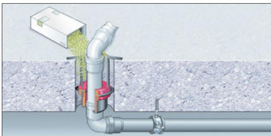
Fig. 5 : Exemple : fourreau de protection incendie
