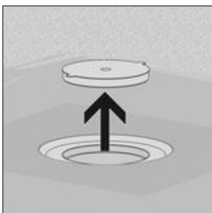
**INFORMATION !** Pour que l'eau d'infiltration éventuellement présente puisse s'écouler sans obstacle, aucun joint anti-retour ne doit être utilisé !
