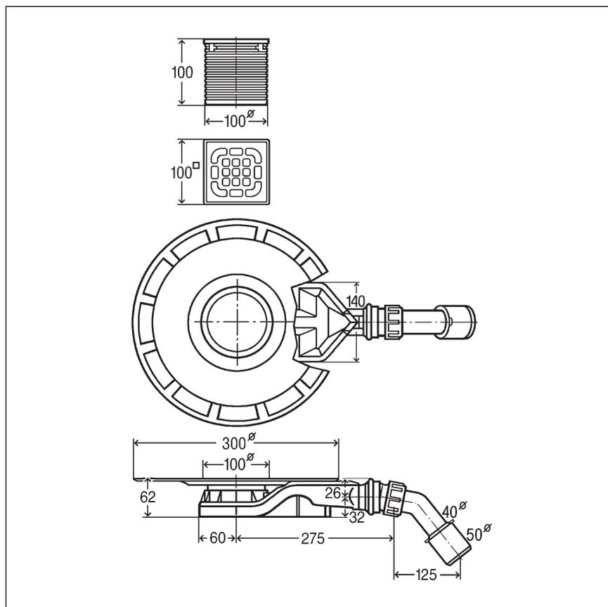
Fig. 6 : Schéma coté modèle 4980.61
