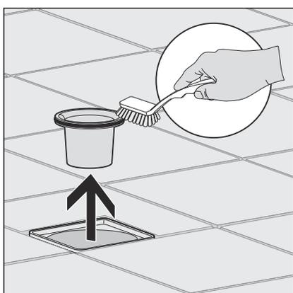
► Retirer le tube plongeur et le nettoyer.
