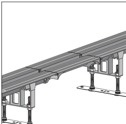
La pièce de liaison permet de relier deux unités de base l'une à l'autre. Dans ce cas, l'une des deux unités de base doit être raccourcie de la longueur de la pièce de liaison (= 210 mm).
