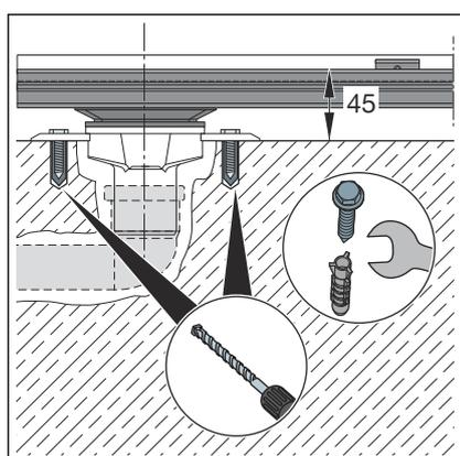
Le raccord d'écoulement peut être fixé à l'aide des pattes de fixation latérales afin d'éviter un glissement.
