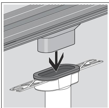
**INFORMATION !** Le raccord d'écoulement peut être fixé dans le plancher en béton grâce aux pattes de fixation latérales.
