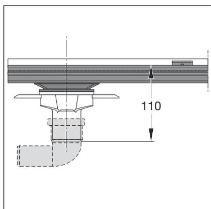
La hauteur de montage du bord supérieur de bride jusqu'au bord inférieur du raccord d'écoulement s'élève à 110 mm.
