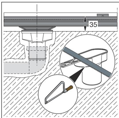
En séparant les pattes de fixation latérales, la hauteur de montage peut être réduite à 35 mm.
