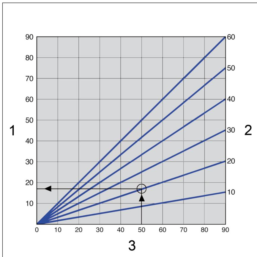
Fig. 2 : Dilatation longitudinale des tubes en cuivre
