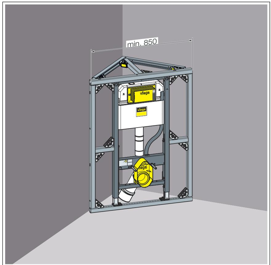
Fig. 7 : Dimensions pour montage en angle
