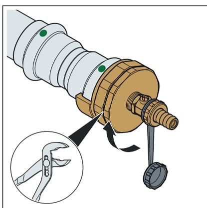
► Si un défaut d'étanchéité survient lors du remplissage d'une installation, resserrer le bouchon de montage à l'aide d'un outil adapté.
