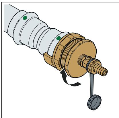
► Visser en place le bouchon de montage et le serrer à la main.
