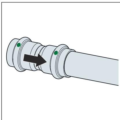
➤ Glisser le raccord à sertir sur le tube jusqu'à la butée.
