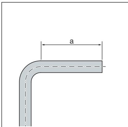
Les tubes des diamètres  $d$  15, 18, 22 et 28 peuvent être cintrés à froid à l'aide de dispositifs de cintrage disponibles dans le commerce (rayon minimal  $3,5 \times d$ ).
