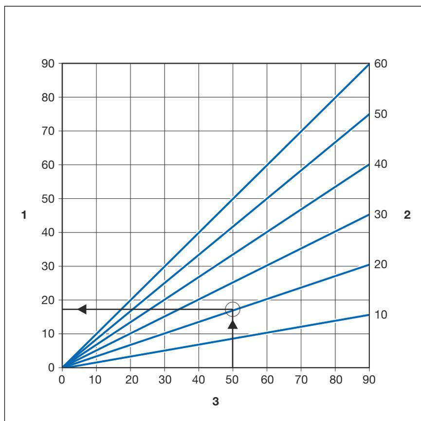
**Fig. 2: Dilatation longitudinale des tubes Sanpress**
