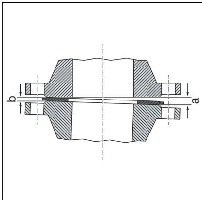
**Système pour le serrage des boulons**
