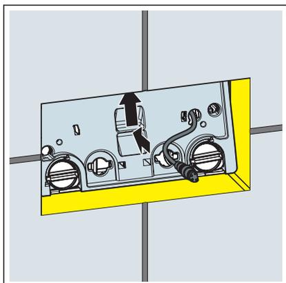
► Mettre en place la plaque de recouvrement dans le réservoir de chasse d'eau.
