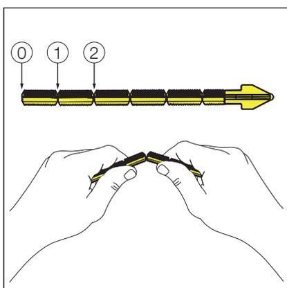
► Si nécessaire, raccourcir la tige d'actionnement à mesure.
