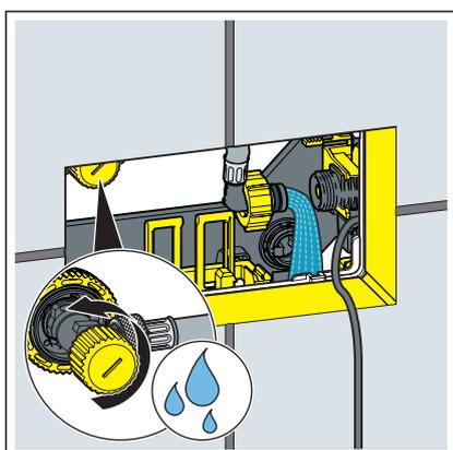
► Afin de rincer la conduite, ouvrir le robinet d'arrêt pendant quelques secondes.
