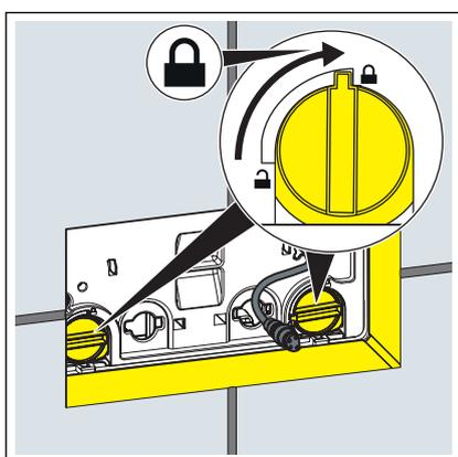
► Tourner le verrouillage de la plaque de recouvrement de 90° dans le sens des aiguilles d'une montre.
