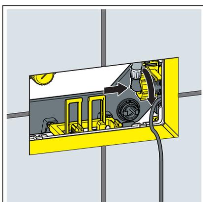
► Raccorder le flexible au robinet flotteur.
