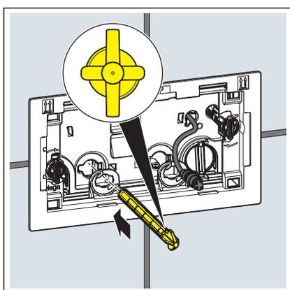
► Insérer la tige d'actionnement jusqu'à la butée à travers l'ouverture gauche du cadre de montage.
