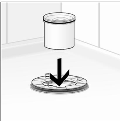
► Insérer le tube plongeur dans le siphon.
