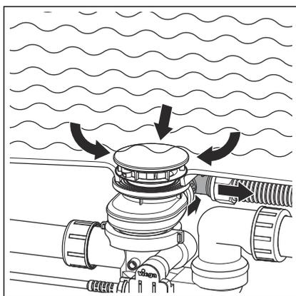
Situation de reflux : dans les situations de dépression, l'eau du bain peut refluer vers l'installation d'eau potable en cas de baignoire pleine.
