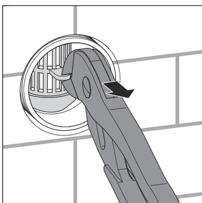
► Retirer l'insert du boîtier à l'aide d'une pince multiprise.
