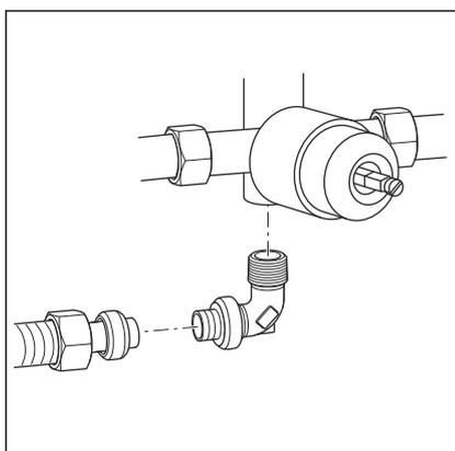
**INFORMATION !** Les illustrations ci-contre montrent le montage avec le raccord à fiche Viega. Le montage peut également être réalisé avec un matériel de raccordement différent. Observez la notice du fabricant le cas échéant.
