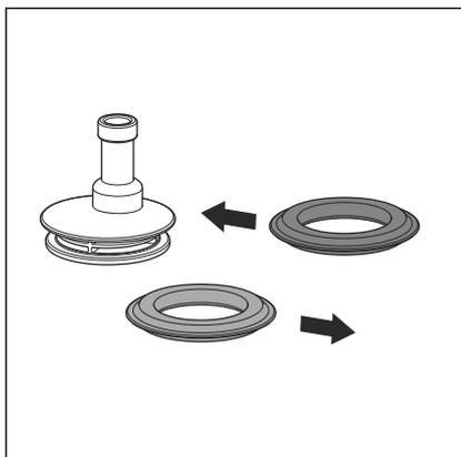
► Si le joint du clapet est endommagé ou s'il présente d'importants dépôts de calcaire, retirer le joint.
