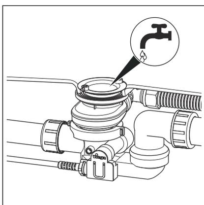
► Nettoyer le corps du vidage sous l'eau courante et à l'aide d'un produit de nettoyage doux si nécessaire.
