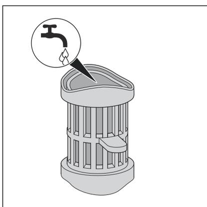
► Si seulement de légers dépôts de calcaire et une salissure modérée sont constatés, rincer l'insert précautionneusement.
