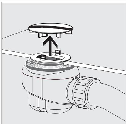
► Enfoncer le tube de surverse Domoplex sur les deux vis de fixation.
