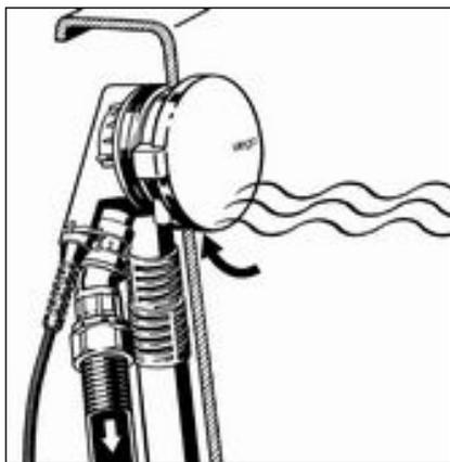
Situation de reflux : dans les situations de dépression, l'eau du bain peut refluer vers l'installation d'eau potable en cas de baignoire pleine.
