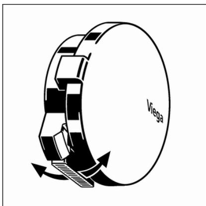
► Pousser le brise jet vers l'avant ou l'arrière avec le doigt. Selon l'orientation réglée, l'eau s'écoule plus près ou plus loin de la paroi de la baignoire.
