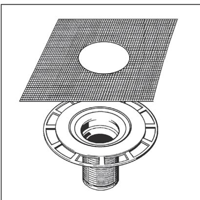
Si une étanchéité composite doit être réalisée, un élément de rehausse adapté avec bavette d'étanchéité est requis.
