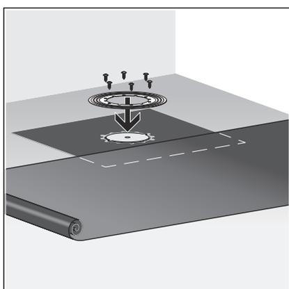
► Ajuster la bride d'étanchéité sur la bavette d'étanchéité de sorte que les trous pour vis soient visibles.
