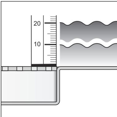
Débit d'écoulement avec une hauteur d'eau de 20 mm au-dessus de la grille : 0,4 l/s
