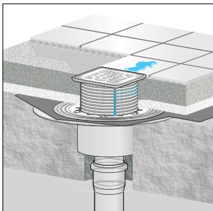
Fig. 2: Exemple de montage général – carottage
