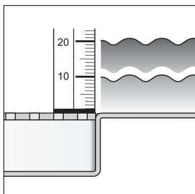
Débit du vidage avec une hauteur d'eau de 10 mm au-dessus de la grille : 0,4 l/s
