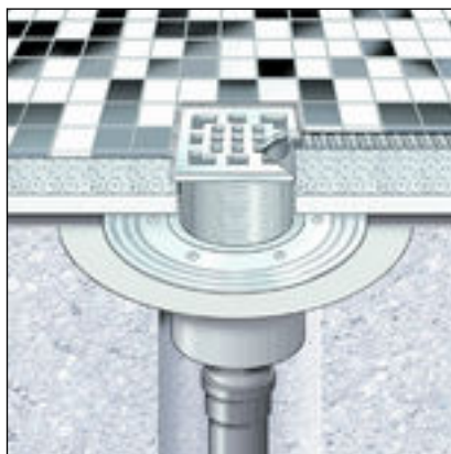
Fig. 3: Schéma d'une étanchéité conventionnelle
