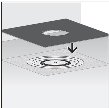
**INFORMATION !** La bavette d'étanchéité Viega est dotée d'un revêtement différent des deux côtés. Un côté est revêtu de bitume et l'autre d'EPDM. Si l'étanchement se poursuit à l'aide de bandes d'étanchéité en bitume, la bavette d'étanchéité doit être utilisée avec le côté bitume vers le haut. Si des bandes d'étanchéité en EPDM sont utilisées, le côté EPDM doit être orienté vers le haut.
