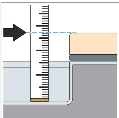
► Calculer la hauteur requise à partir du fond de la rigole de douche jusqu'au bord supérieur du carrelage.
