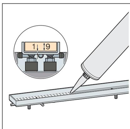
**INFORMATION !** La hauteur de revêtement, y compris la colle, est de 10 mm jusqu'au bord supérieur de la cavité ! Le revêtement peut dépasser le bord supérieur de la cavité.
