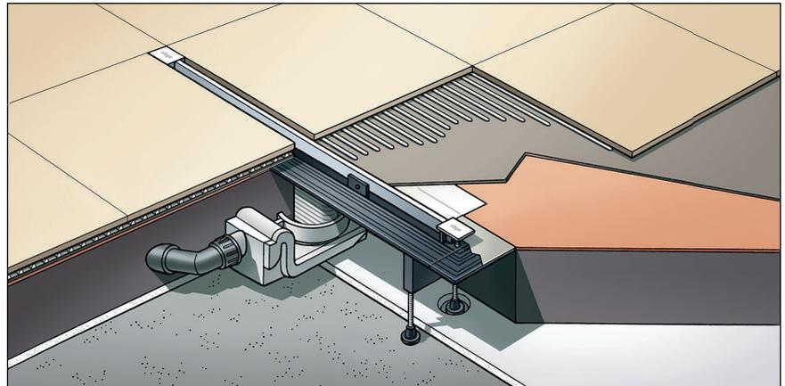
Fig. 13: Schéma d'une étanchéité composite
