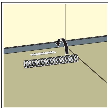
► Mettre en place le panier dans la fente de la rigole au-dessus du vidage.
