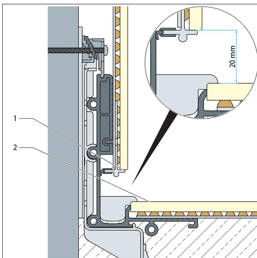
Fig. 21: Profilé de finition monté, carrelage mural et carrelage du sol posés
