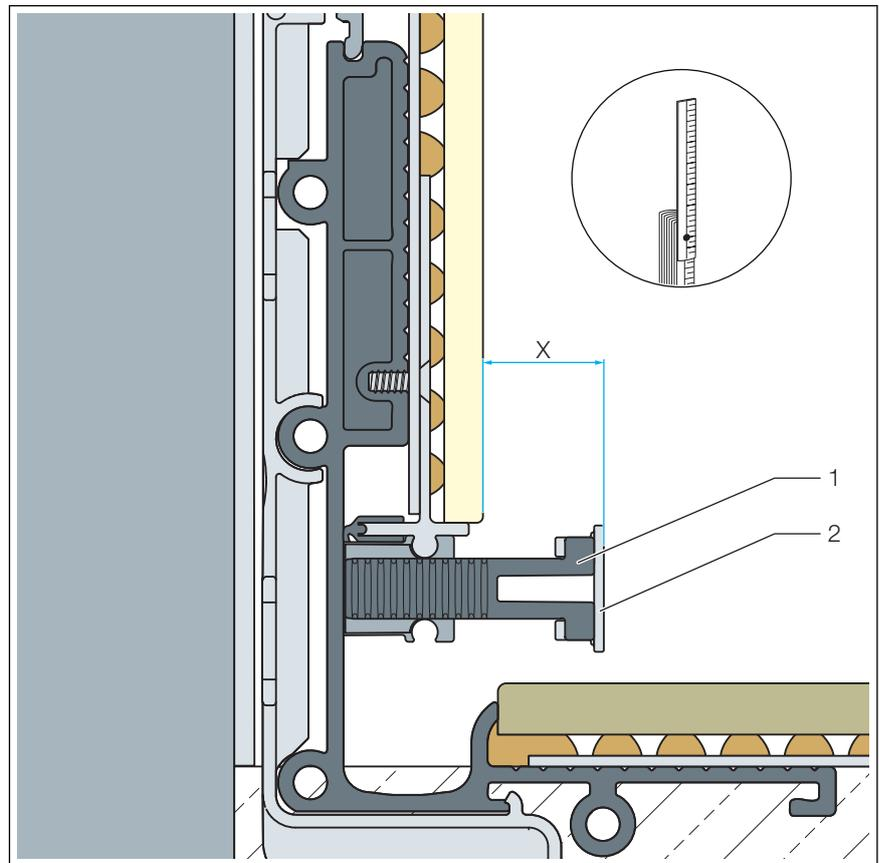
Fig. 24: Détermination de la cote du support pour élément de finition
