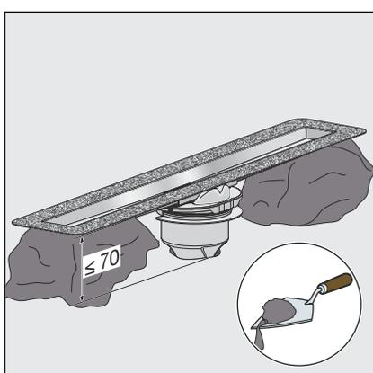
► Pour les hauteurs de montage jusqu'à 70 mm, aligner l'unité de base dans le lit de mortier.
