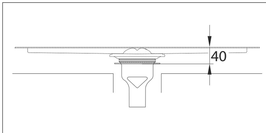
Fig. 2: Hauteur de montage pour modèle 4982.94
