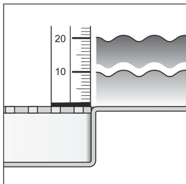
Le débit d'écoulement avec une hauteur d'eau de 10 mm au-dessus de la grille s'élève à 0,9 l/s.
