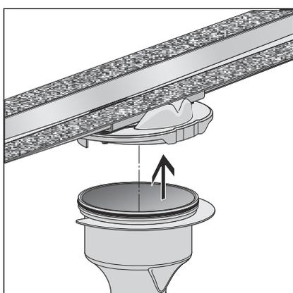
► Enfoncez le vidage dans l'élément de raccordement jusqu'à l'encliquetage.
