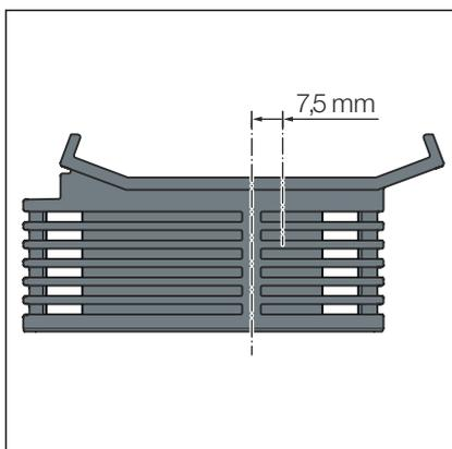
► Afin de pouvoir adapter le profilé de rigole de douche au motif de pose du carrelage, le logement du profilé est excentré de 7,5 mm.
