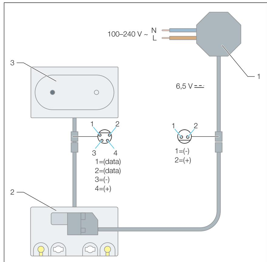
**Fig. 2: Schéma de raccordement, bloc d'alimentation, commande à distance pour Prevista**
