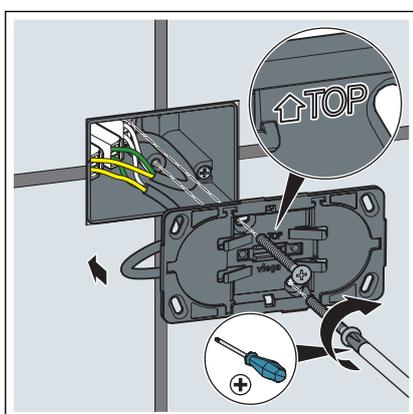
➤ Fixer le cadre de montage de la commande à distance dans la boîte d'encastrement.
