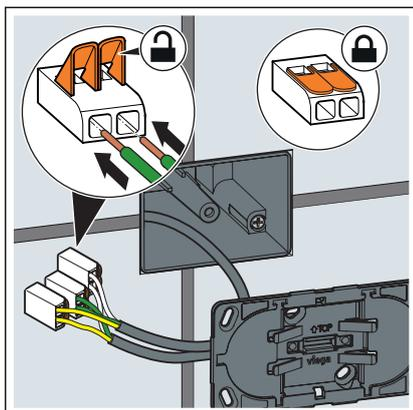
➤ Raccorder la rallonge au cadre de montage de la commande à distance.
