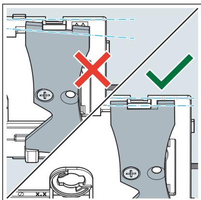
► Contrôler et corriger le cas échéant le positionnement des plaques de sécurité.
