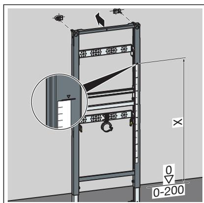
► Régler la hauteur de construction de l'élément d'après le marquage du bord supérieur du sol fini réalisé sur place.
