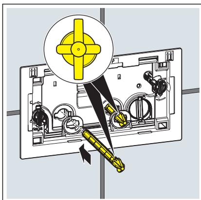
► Insérer les tiges d'actionnement jusqu'à la butée.
