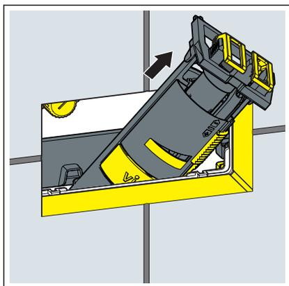
► Retirer la soupape d'évacuation par la trappe d'accès.
