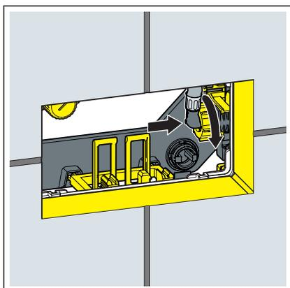
► Raccorder le flexible au robinet flotteur.
