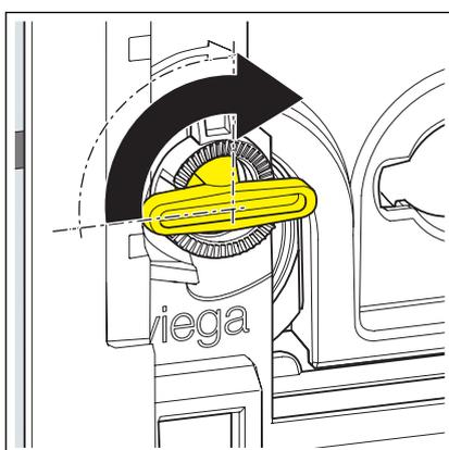
► Tourner les goupilles de 90° dans le sens des aiguilles d'une montre.
