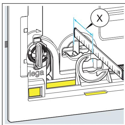
**INFORMATION !** En cas de montage par l'avant dans les réservoirs de chasse d'eau encastrés 3H, 3L, 3F.
