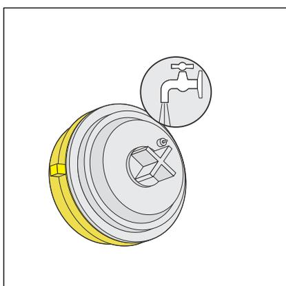
► Nettoyer la vanne à membrane sous l'eau courante au besoin.
