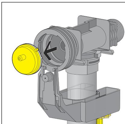
► Démonter la vanne à membrane.
