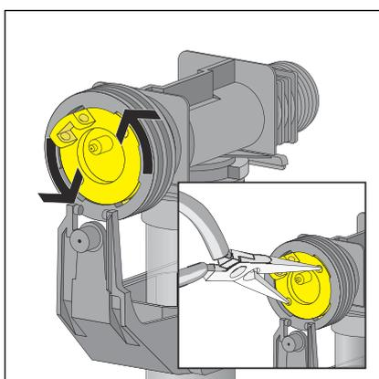
► Desserrer la couronne de fixation en la tournant de 45° dans le sens inverse des aiguilles d'une montre à l'aide d'une pince à long bec.
