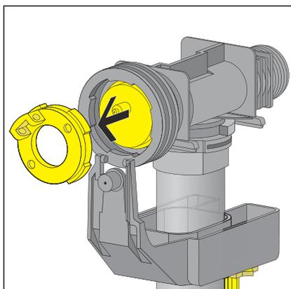
► Démonter la pièce de fermeture droite.
