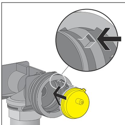
► Monter la vanne à membrane en veillant à sa mise en place correcte.
